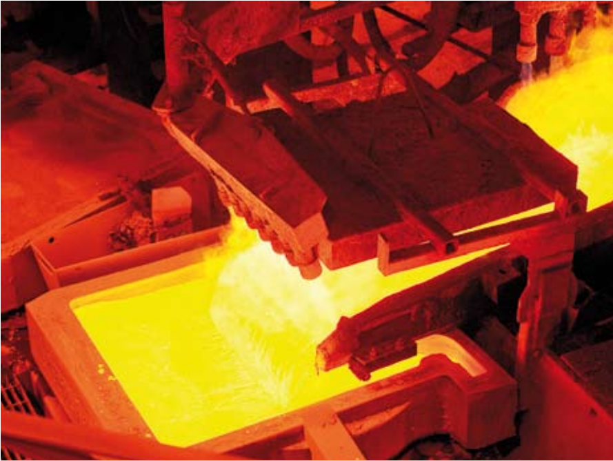
Mejorar el control de la temperatura en la rueda de moldeo de ánodos es una de las diversas iniciativas de Fundición Horne para disminuir su consumo de gas natural.
